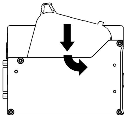
Fig. 0-8: Insert the ink cartridge
